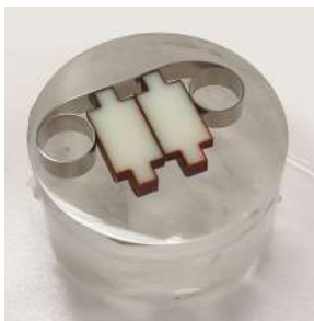
Figure 3.19 – Échantillon découpé, enrobé et poli. La couche oxydée est la zone brunie sur le pourtour de chaque moitié d'échantillon.
